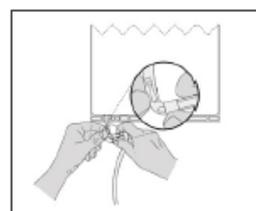
Brechen der Brechkonnectoren bei beiden Anschlüssen; Flüssigkeit kann fließen
