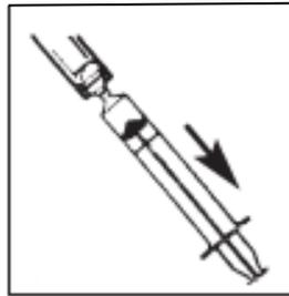
Luer-Lock-Konnekction verhindert Ventilierung. Flüssigkeit kann nur mit Kraftaufwand in die Spritze aufgezogen werden.
