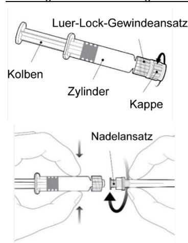
Halten Sie die Spritze am Zylinder, nicht am Kolben.
