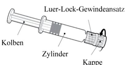
Halten Sie die Spritze am Zylinder, nicht am Kolben. Drehen Sie die Spritzenkappe entgegen dem Uhrzeigersinn ab.
