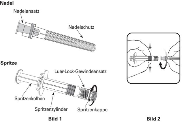
Halten Sie die Spritze immer am Zylinder, nicht am Spritzenkolben oder am Luer-Lock-Gewindeansatz. Halten Sie die Nadel und die Spritze in einer Linie ausgerichtet (wie in Bild 2 dargestellt), anderenfalls kann sich der Luer-Lock-Gewindeansatz verziehen und undicht werden.
