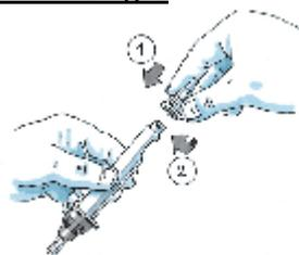
Schrauben Sie die Injektionsnadel im Uhrzeigersinn auf das vordere Gewinde des Injektors, bis sie fest sitzt.
