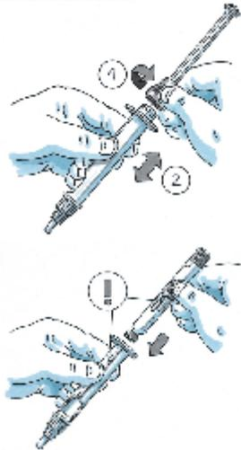
Schrauben Sie den Stempel vom Injektor ab. Nehmen Sie die Karpule und reinigen Sie die Spitze mit einem desinfizierenden Tupfer. Führen Sie die Karpule in den transparenten Körper des Injektors ein. Achten Sie darauf, die Wölbung der Karpule in die Nut des Injektors einzuschieben.
