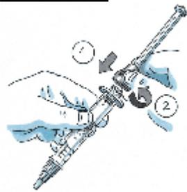
Schrauben Sie den Stempel wieder auf den hinteren Gewindeteil des Injektorkörpers.
