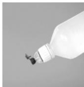
Flasche mit aufgesetztem Spike zur aseptischen Entnahme der Lösung.
