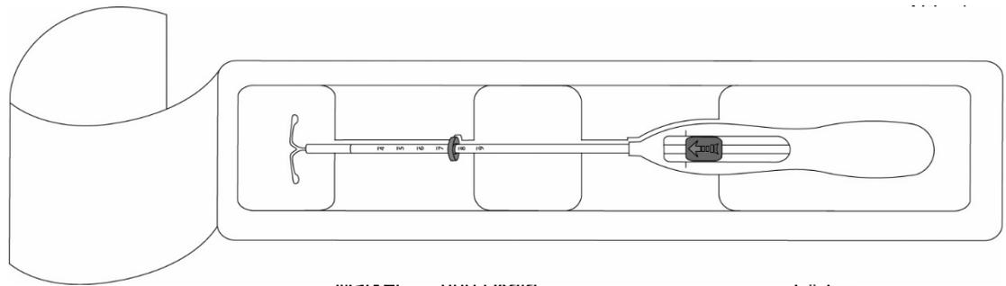
2. Drücken Sie den Schieber in Pfeilrichtung bis zur äußersten Position **nach vorne**, um Mirena in das Insertionsröhrchen zu laden (Abb. 2).
