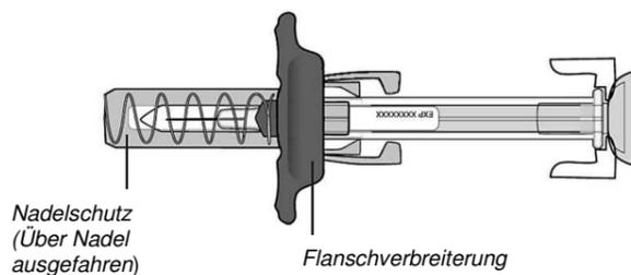
Die Fertigspritze verfügt über eine **Flanschverbreiterung**, die es einfacher macht diese zu halten und zu injizieren, und über einen **Nadelschutz**, der die Nadel nach einer vollständigen Injektion automatisch bedeckt.
