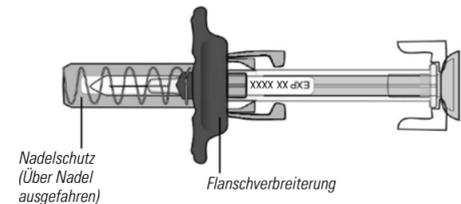
Die Fertigspritze verfügt über eine **Flanschverbreiterung**, die es einfacher macht diese zu halten und zu injizieren, und über einen **Nadelschutz**, der die Nadel nach einer vollständigen Injektion automatisch bedeckt.
