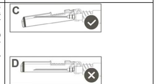
**Vorsicht: Versuchen Sie nicht, die Sicherheitsvorrichtung zu entriegeln (deaktivieren), indem Sie die Kanüle aus dem Schutzschild herausdrücken.**
