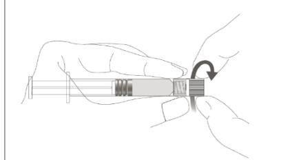
**Schritt 2:** Um die Nadel an der Spritze anzubringen, drehen Sie die Nadel vorsichtig in den Luer-Lock-Adapter der Spritze, bis Sie einen leichten Widerstand spüren.
