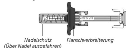
Die Fertigspritze verfügt über eine **Flanschverbreiterung**, die es einfacher macht diese zu halten und zu injizieren, und über einen **Nadelschutz**, der die Nadel nach einer vollständigen Injektion automatisch bedeckt.
