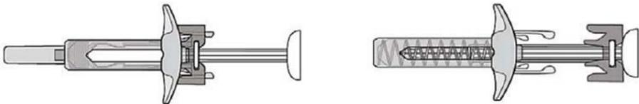
Abbildung C: Stickschutz ist nicht aktiviert – die Spritze ist einsatzbereit
