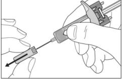
Abbildung G: Abziehen der Schutzkappe
