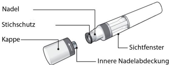
Abbildung A: Teile des Hyrimoz-SensoReady-Pens
