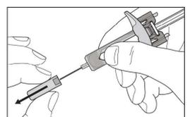
Abbildung G: Abziehen der Schutzkappe
