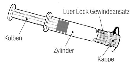
Halten Sie die Spritze am Zylinder, nicht am Kolben.
