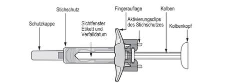
Abbildung A: Hyrimoz-Fertigspritze mit Stichschutz und Fingerauflage
