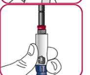
8. Schrauben Sie die Patrone mit nach oben zeigender Nadelkappe im Uhrzeigersinn auf den Pen, bis Patrone und Pen ohne Spalt miteinander verbunden sind.
