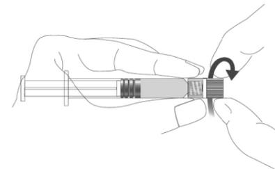
**Schritt 2:** Um die Kanüle an der Spritze anzubringen, drehen Sie die Kanüle vorsichtig in den Luer-Lock-Adapter der Spritze, bis Sie einen leichten Widerstand spüren.
