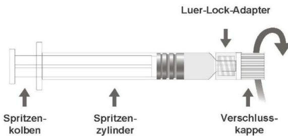
**Schritt 1:** Halten Sie den Luer-Lock-Adapter mit einer Hand fest (vermeiden Sie es dabei, den Spritzenkolben oder Spritzenzylinder festzuhalten), und schrauben Sie die Verschlusskappe durch Drehen ab.
