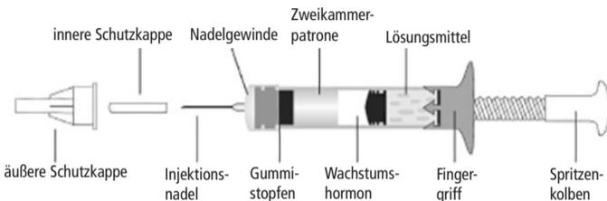
In der einen Kammer der Zweikammerpatrone Genotropin MiniQuick befindet sich das Wachstumshormonpulver, während die andere Kammer das Lösungsmittel enthält. Wenn Sie den Spritzenkolben im Uhrzeigersinn drehen, vermischen sich das Wachstumshormonpulver und das Lösungsmittel, und das Pulver löst sich auf.
