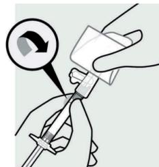
Die Spritze mit der Spritzenspitze nach oben halten. Befestigen Sie die Sicherheitskanüle mit einer leichten Drehbewegung an der Spritze, um ein Brechen oder eine Beschädigung der Farbcodierung am Kanülenansatz zu vermeiden. Prüfen Sie vor der Anwendung immer auf Anzeichen einer Beschädigung oder Undichtigkeit.
