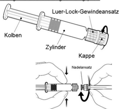
Halten Sie die Spritze am Zylinder, nicht am Kolben.
