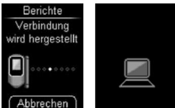
Während des Verbindungsaufbaus werden Sie in der Anzeige über diesen Vorgang informiert. Das PC-Symbol in der Anzeige des Messgerätes blinkt bei erfolgreicher Verbindung mit dem Computer.
