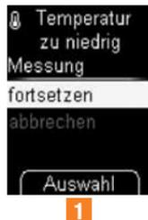
Diese Meldung erscheint am Beginn einer Messung, wenn die Umgebungstemperatur oder die Temperatur des Messgerätes zwischen +8 und +10 °C **1** oder zwischen +40 und +42 °C **2** liegt.
