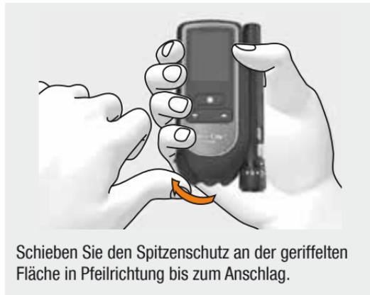
Schieben Sie den Spitzenschutz an der geriffelten Fläche in Pfeilrichtung bis zum Anschlag.
