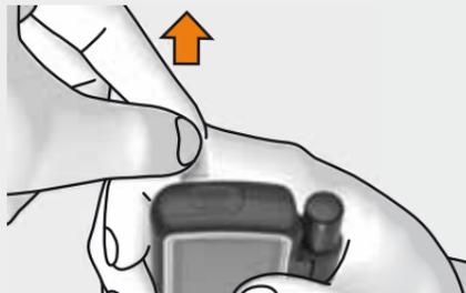
Ziehen Sie die Schutzfolie der Batterien nach hinten aus dem Messgerät.
