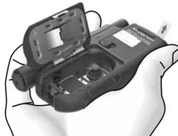
Der Kassettenfachdeckel ist vollständig geöffnet, wenn er – wie in der Abbildung – etwas nach außen steht.
