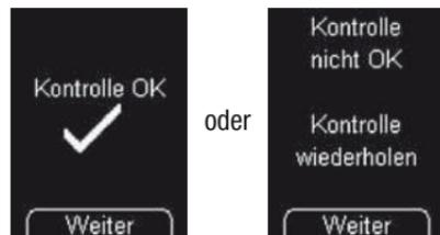
Wenn der Messwert im angezeigten Konzentrationsbereich ist, wird *Kontrolle OK* angezeigt.
