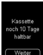
Diese Meldung erscheint am Beginn einer Messung, wenn die Testkassette nur noch 10 Tage haltbar ist. Die Meldung wird wiederholt, wenn die Testkassette noch 5, 2 und 1 Tag(e) haltbar ist.
