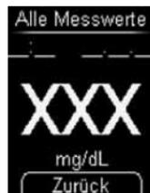
Sind keine Messwerte im Messgerät gespeichert, wird ebenfalls XXX (XX.X) angezeigt.
