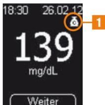
Der Messwert mit der Markierung
